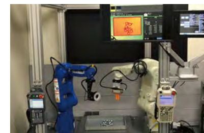
毛髪検査装置 (AIを活用した自動検査装置)
