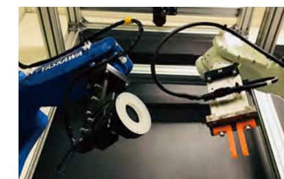
センサ概観検査装置 (3Dロボットビジョンシステム)
